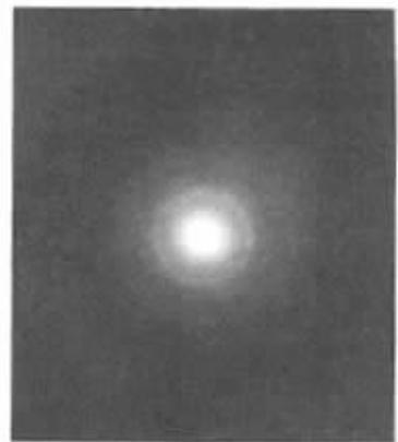
图 2  $\text{Fe}_3\text{O}_4$ -聚苯胺纳米复合物的多晶电子衍射图
