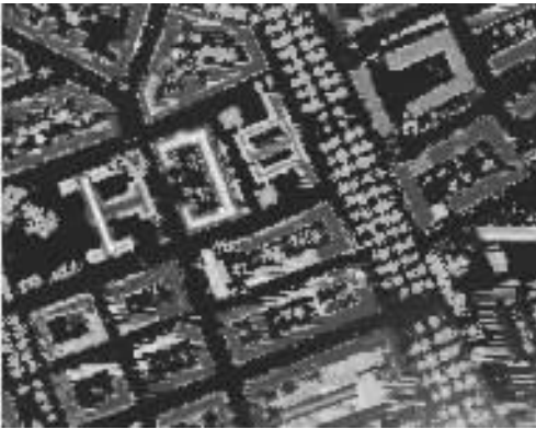
图 1 距离影像 Fig. 1 Range image of Lidar point cloud
