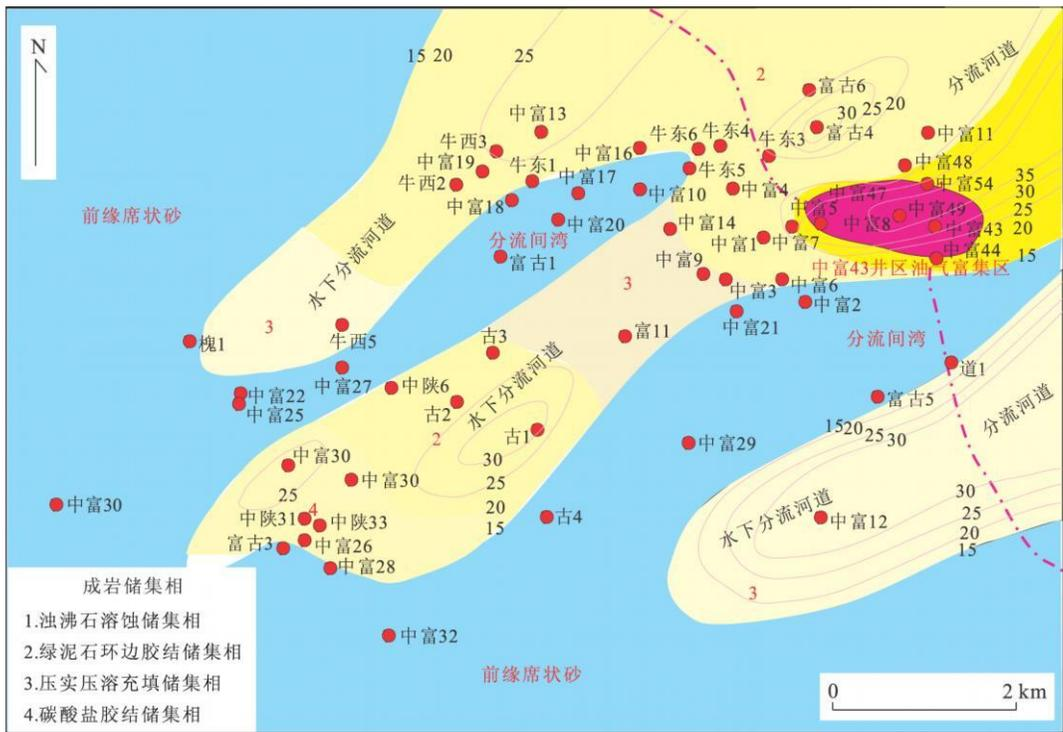
图 5 长 3 油层浊沸石溶蚀储集岩相与油气富集区配置关系
