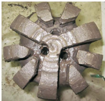
图 11 低温电铸孕镶脉冲石油钻头出井前后的照片对比
