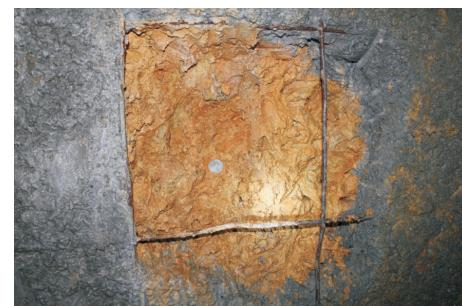
图1 黄土坡滑坡I号支洞滑带土
