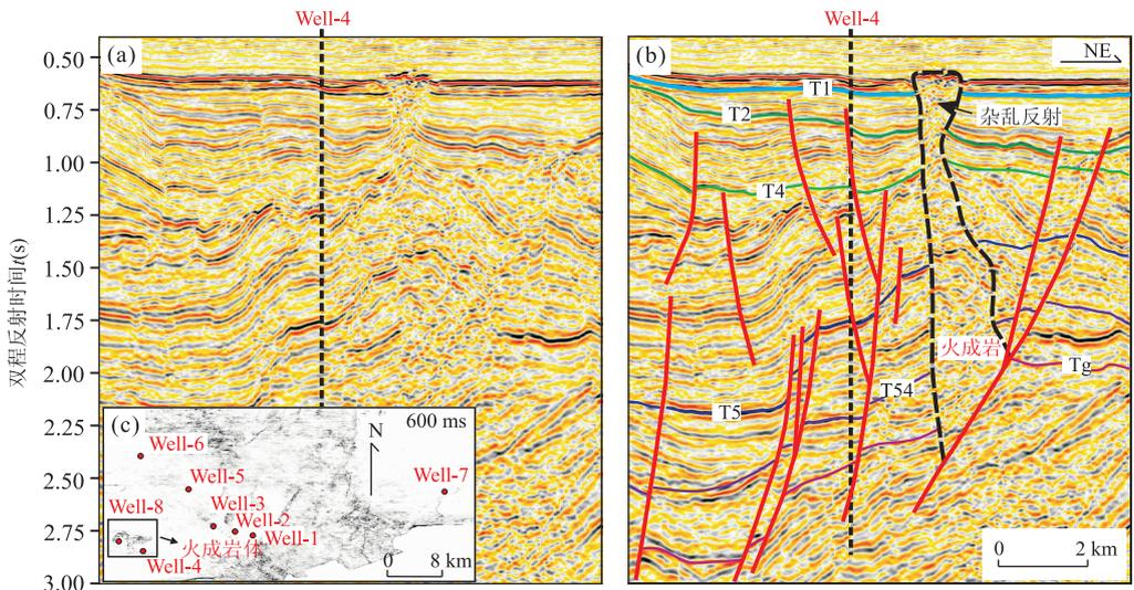
图 4 地震测线 Line-1 显示岩浆岩的喷出构造
