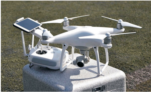
图 1 Phantom 4 无人机及地面控制系统 Fig.1 Phantom 4 UAV and ground control system
