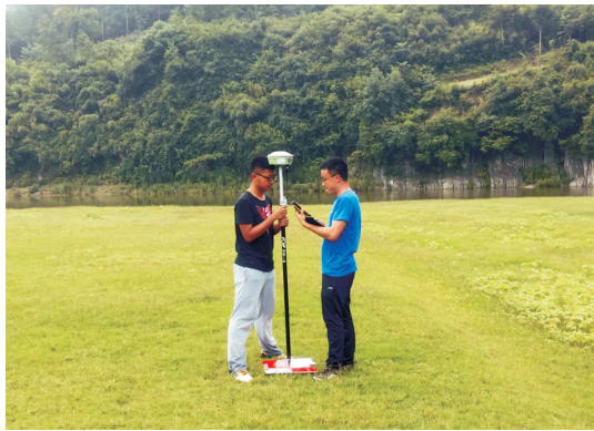
图 3 地面控制点测量 Fig.3 Ground control points measurement
