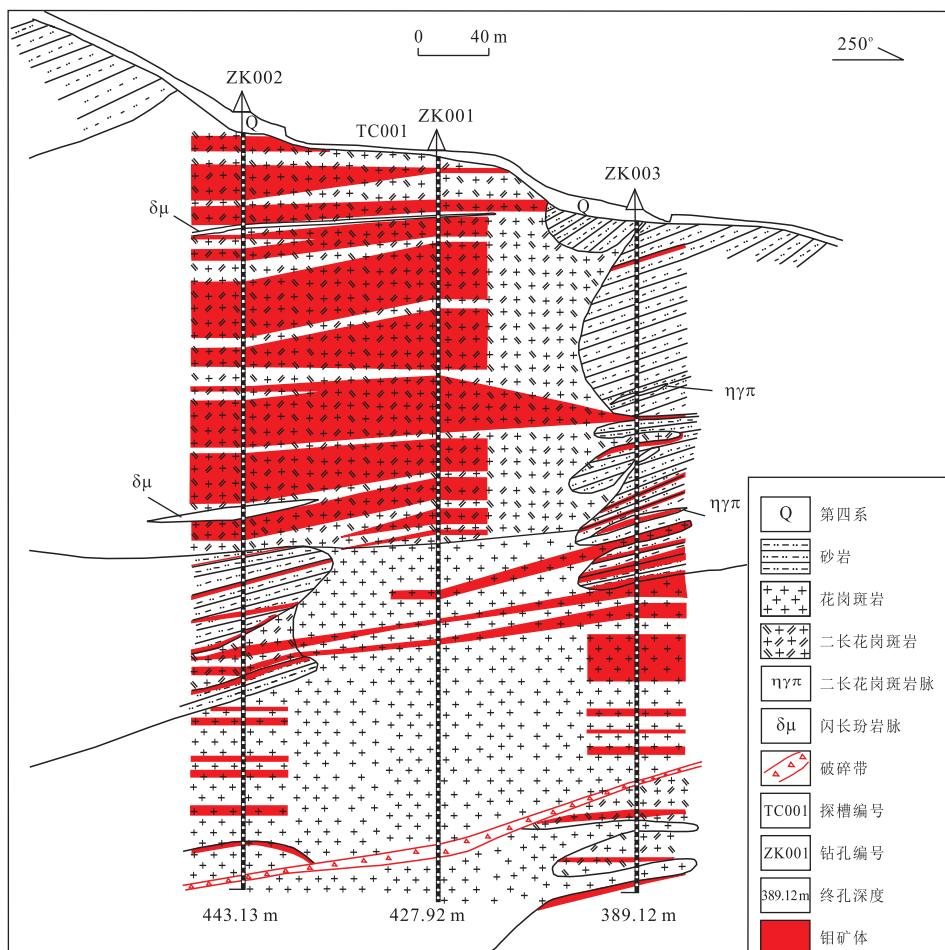
图 5 荣嘎矿区 0 号勘探线剖面
