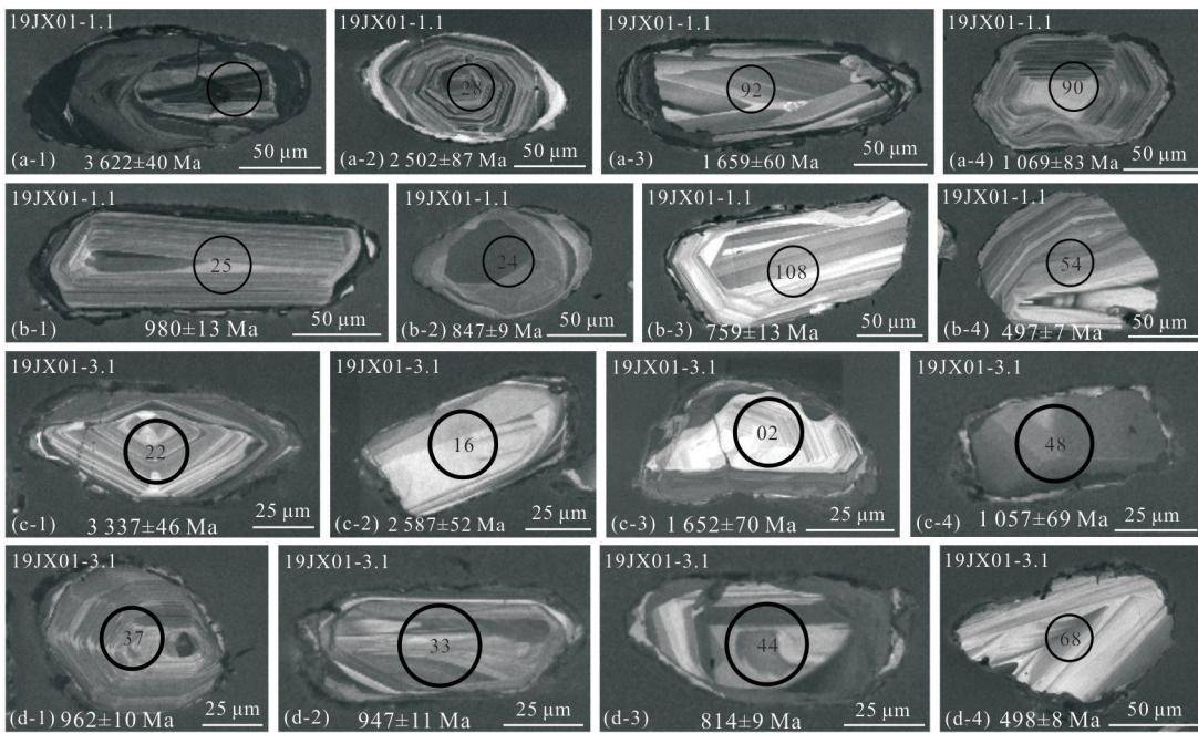
图 3 武功山杂岩高滩组含榴云母石英片岩中碎屑锆石的阴极发光图像与 U-Pb 年龄
