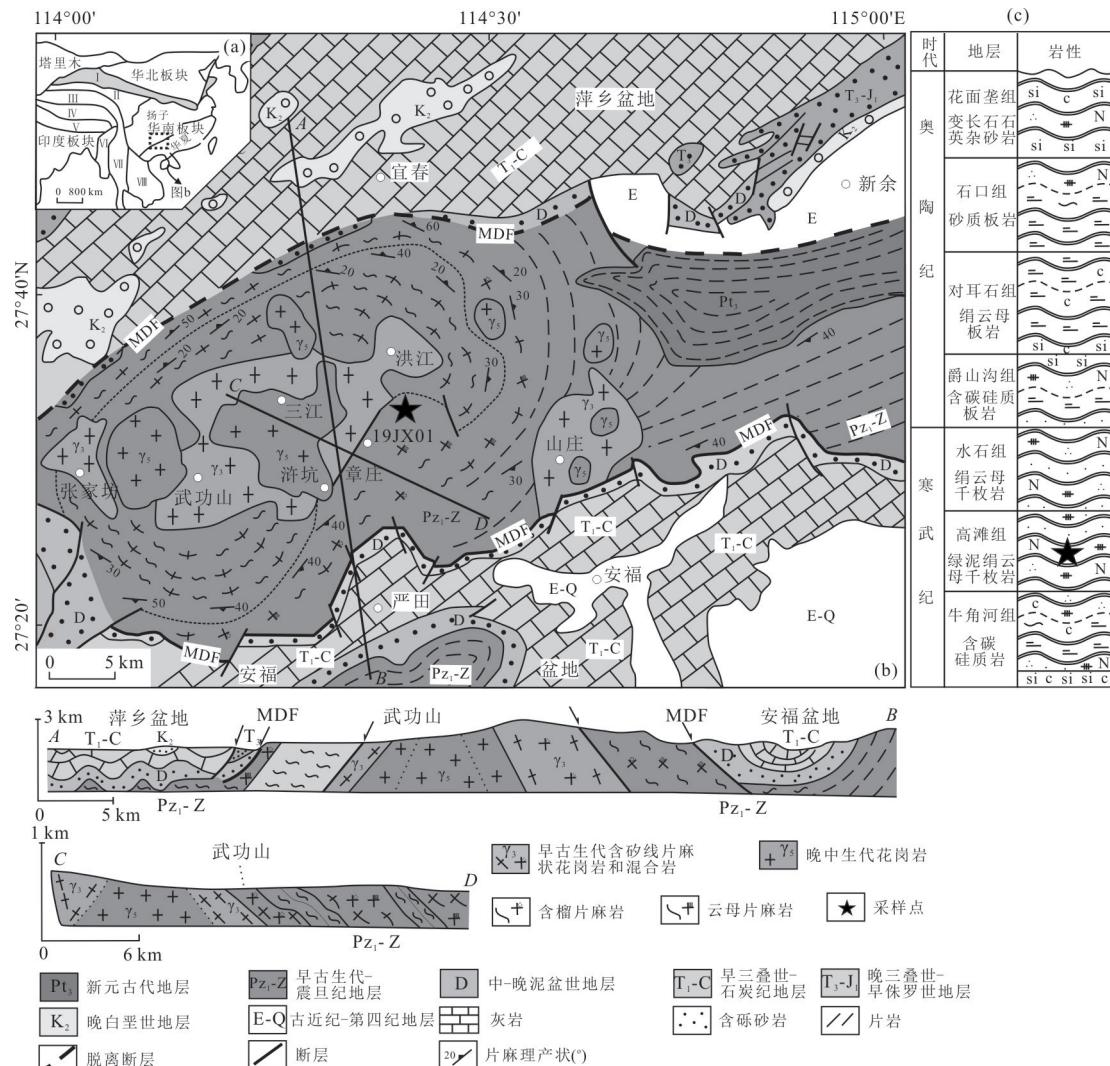
图1 武功山大地构造位置简图(a;修改自 Metcalfe, 2013),武功山区域地质简图(b;修改自 Shu *et al.*, 1998),柱状图及采样位置(c;修改自马虎超等,2019)
