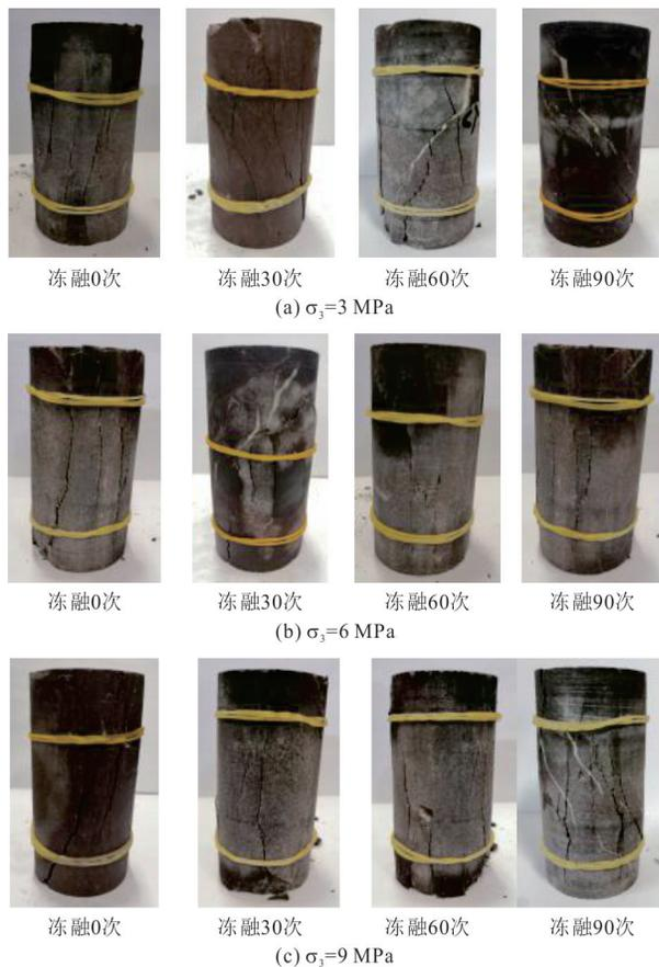
图 17 砂岩试样卸围压试验破坏照片
