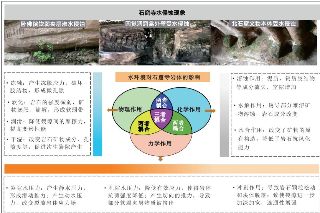
图6 水岩作用下石窟寺岩体的劣化破坏机理
