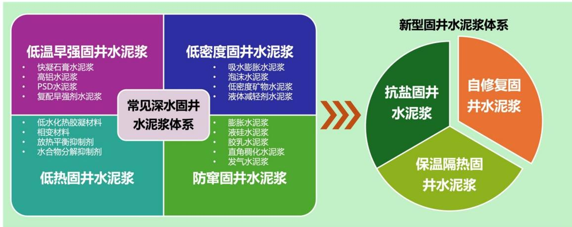
图2 深水固井水泥浆体系概览
