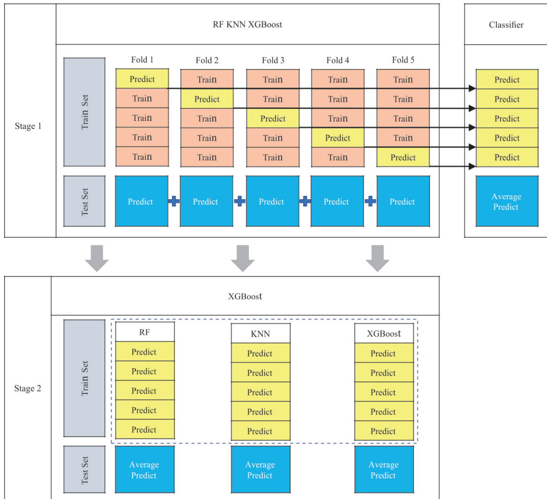
图 5 Stacking 集成策略模型架构
