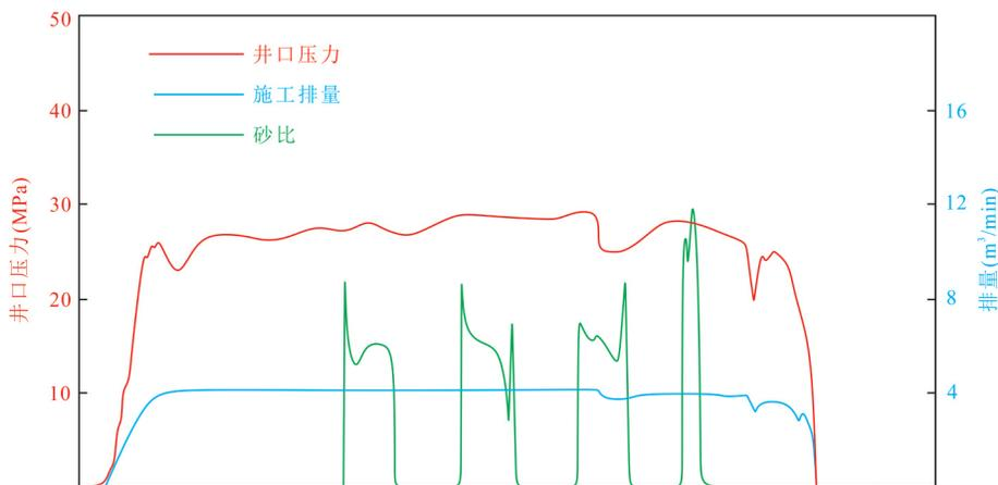
图 16 GRY1 水力加砂压裂压力曲线
