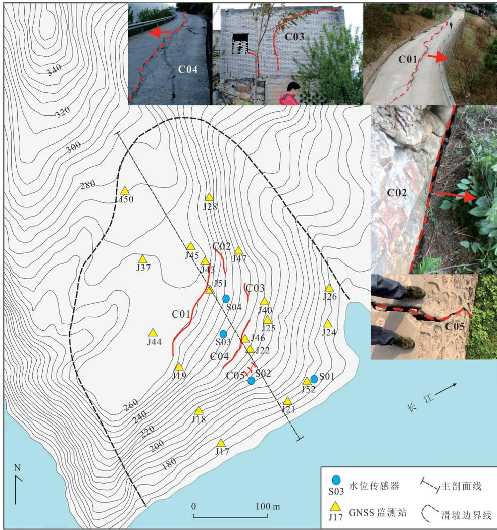
图 4 塔坪滑坡变形破坏迹象
