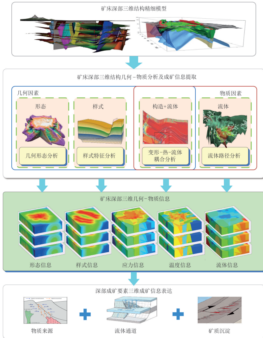
图 2 矿床深部三维结构几何-物质分析及成矿信息提取方法与技术
