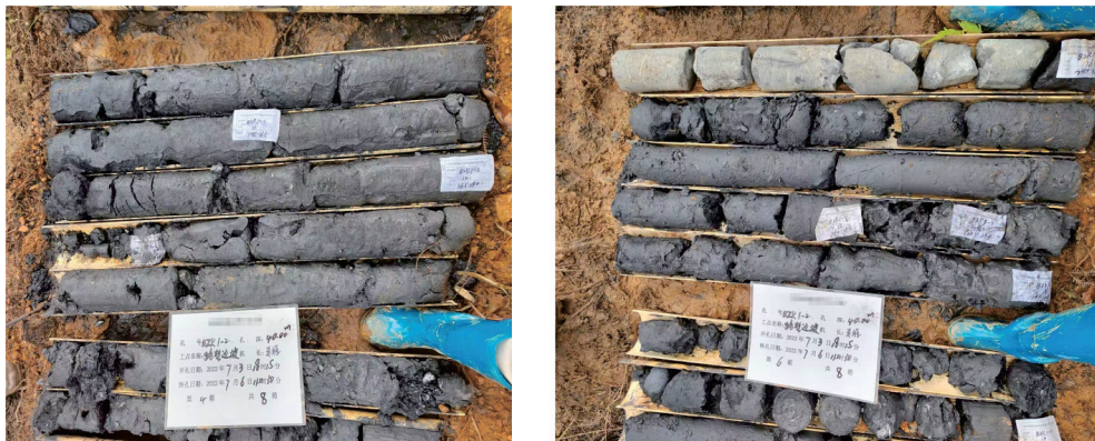
图 5 碳质页岩岩心钻孔图
