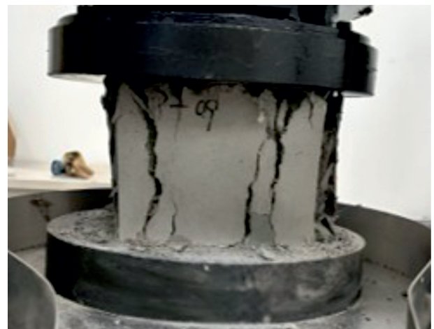
图1 新型混凝土破坏特征
