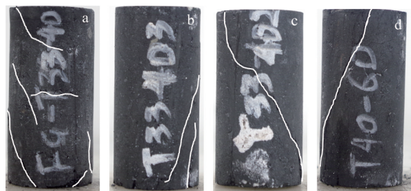
图7 F-T33-4D岩心在不同围压下的破坏形态
