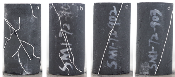
图8 S-72-9D岩心在不同围压下的破坏形态
