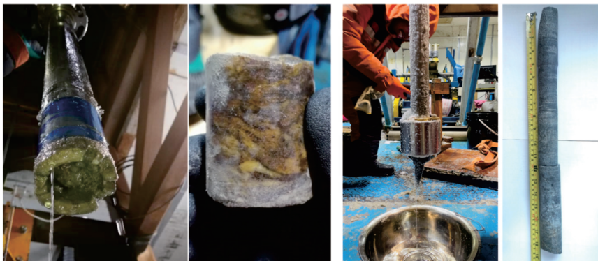
2018—2019 南极工作季冰下基岩样品 2023—2024 南极工作季冰下基岩样品 图 7 IBED 钻机钻取的冰下基岩样品 (张楠等, 2020; Talalay et al. , 2025) Fig.7 The subglacial geological samples obtained by IBED drill
