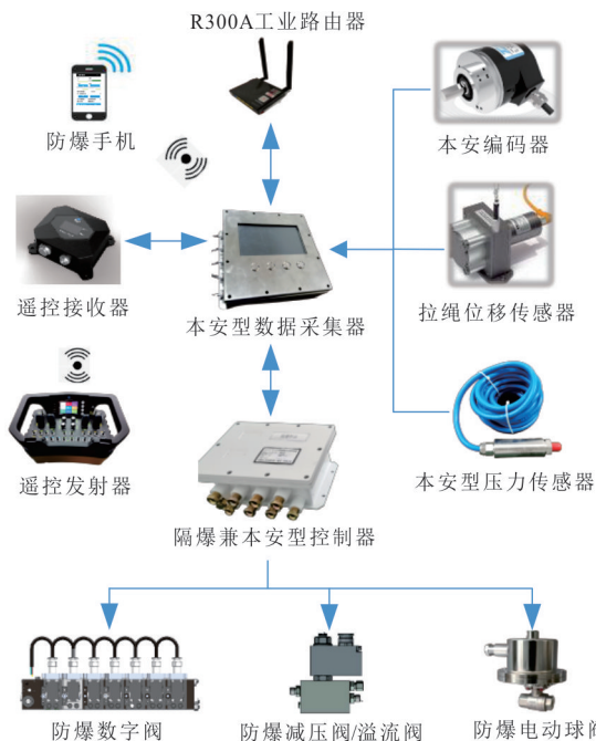
图 11 ZDY10000LDK 钻机电液控制系统组成示意图
