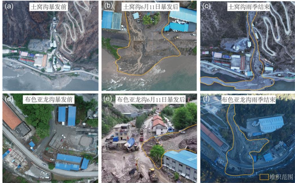
图 4 典型泥石流沟暴发特征。(a)、(b) 和 (c) 分别为土窝沟泥石流暴发前、暴发后和雨季结束后的沟口堆积特征。(d)、(e) 和 (f) 分别为布色亚龙沟泥石流暴发前、暴发后和雨季结束后的沟口堆积特征。
