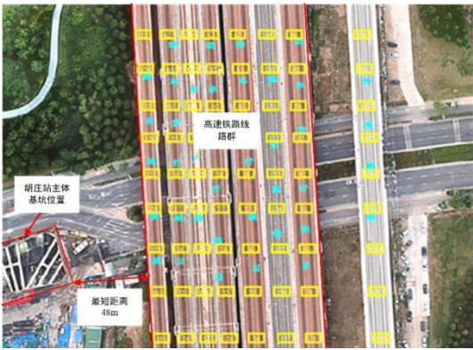
图 2 基坑与桥梁位置平面图
