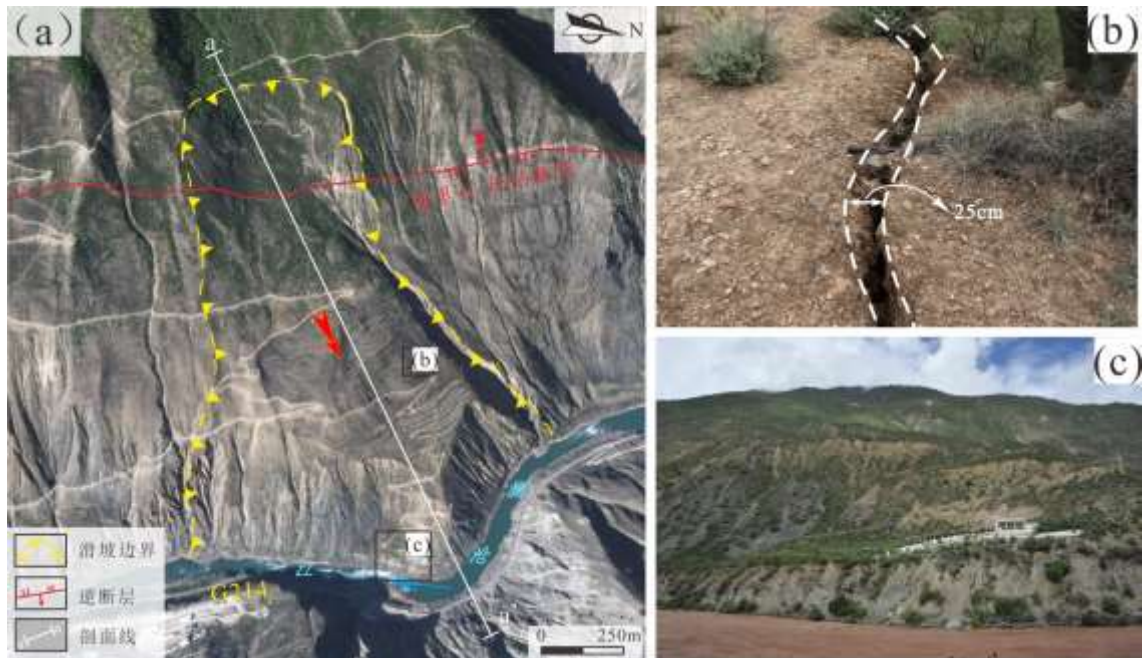
图 10 根达坎滑坡变形特征图 (a. 滑坡平面图; b. 根达坎滑坡前缘左侧裂缝; c. 滑坡前缘湖相沉积层)
