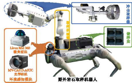
图 1 岩石取样机器人实物图
