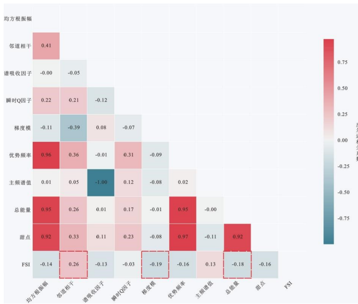
图 6 研究区东二下亚段地震属性与富砂指数 FSI 皮尔逊相关系数矩阵
