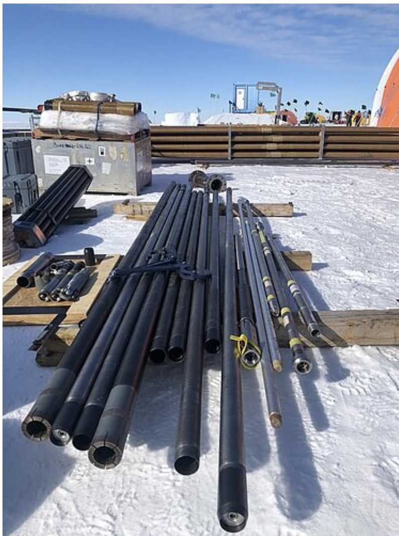
图 9 AIDD 钻机使用的海底沉积物取样钻具（Patterson et al. , 2022）
