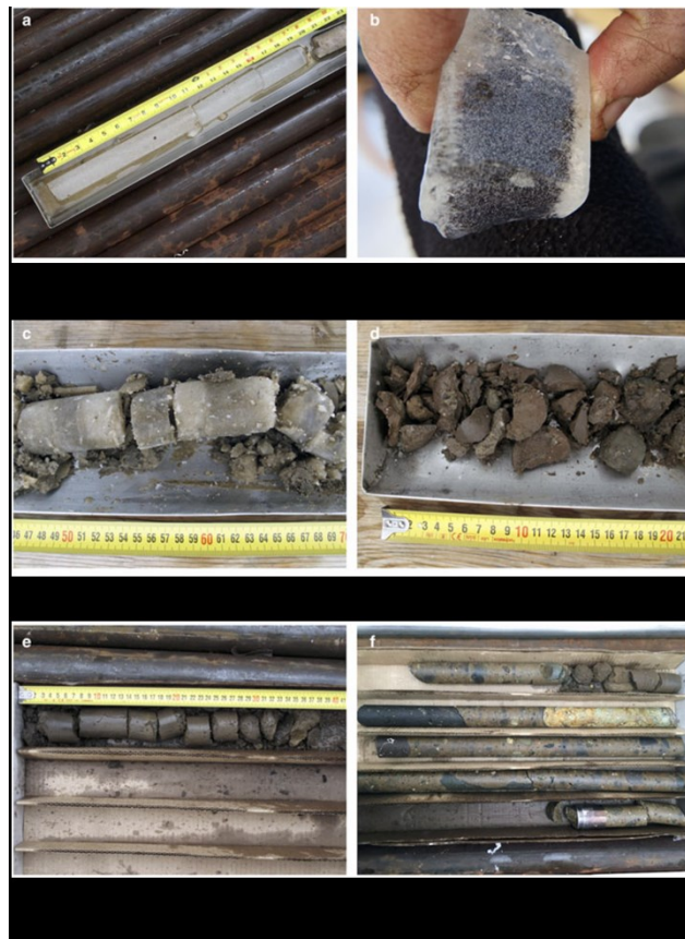
图 6 RAID 钻机获得的冰下地质样品 (Goodge et al. , 2021)
