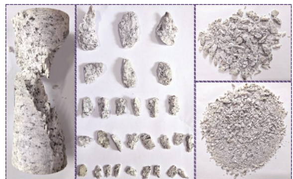
图 11 花岗岩单轴压缩破坏情况
