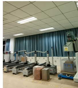
图 7 微钻实验法装置 Fig.7 Micro-drill experimental apparatus
