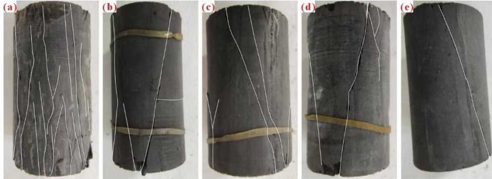
图 5 150°C不同围压试样破坏形态 (a)Y-6 \sigma_3=0 MPa, (b)Y-7 \sigma_3=40 MPa, (c)Y-8 \sigma_3=60 MPa, (d)Y-9 \sigma_3=80 MPa, (e)Y-10 \sigma_3=100 MPa
