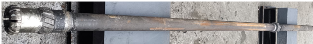
图 15 柔性导向取心钻具现场实物
