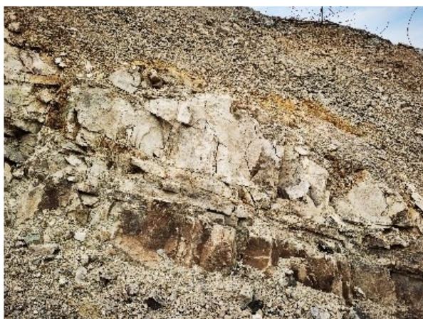
图5-5 泥质粉砂岩软弱夹层
