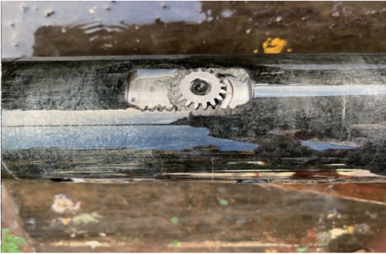
(b) 齿轮-齿条球阀(卢春华等, 2023)
