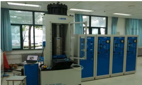
图 5 GCTS-2000 三轴应力实验机
