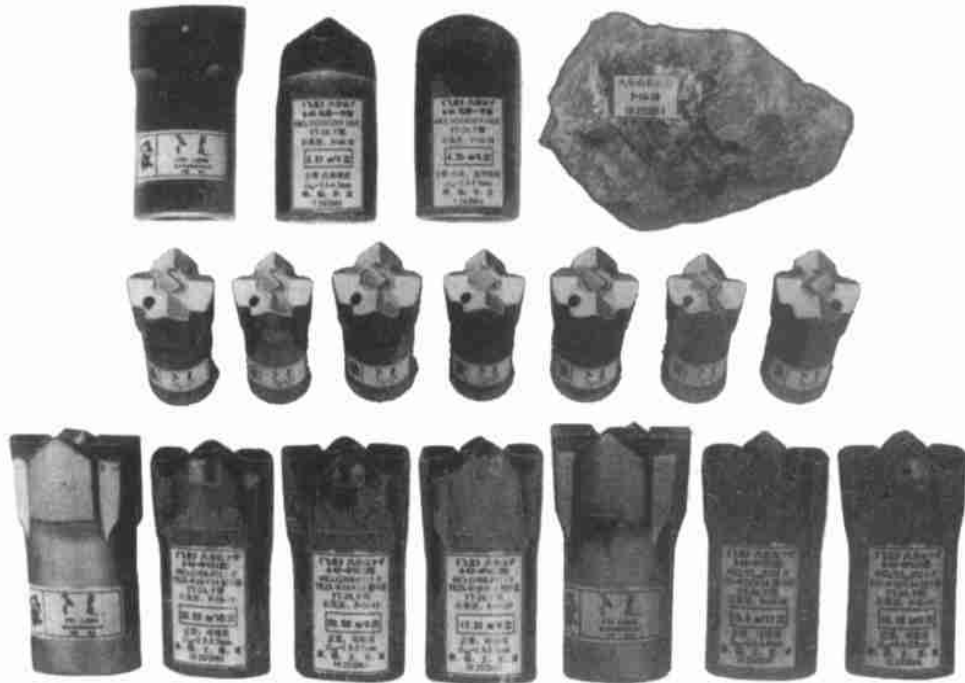
图 5 “飞龙” \phi 40 一字形钎头(YG11C)和 \phi 42-4P1C (YJ2.1R, YG308 边刃)复合钎头工况比较
