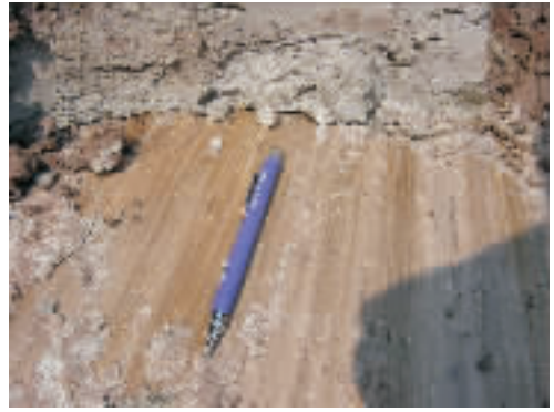
照片2 安乐寺滑坡Y2滑带擦痕(滑动方向为102°)
