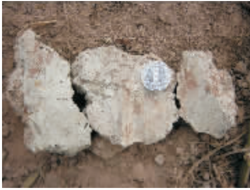
照片1 安乐寺滑坡Y1滑带中的滑面
