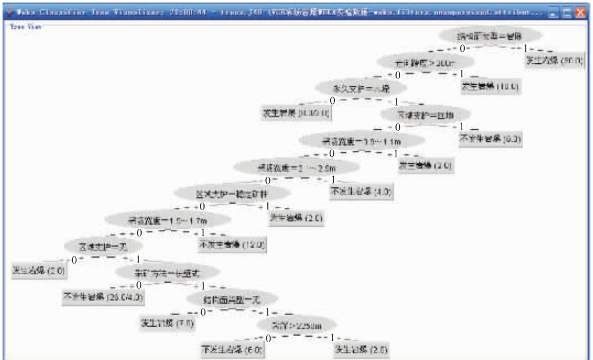
图 2 VCR 采场岩爆实例数据生成的修剪过的决策树
