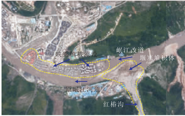
图 6 摄于 2010 年 8 月 15 日的航空照片反映了红椿沟泥石流扇及其壅塞堆积体,以及映秀新镇洪水泛滥灾情(由四川省地质环境监测总站提供)
