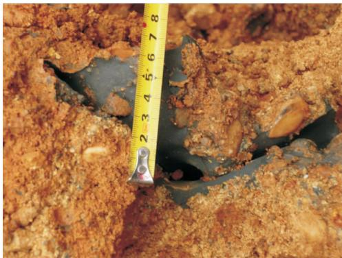
图 5 开挖后填料中存留的劈裂缝
