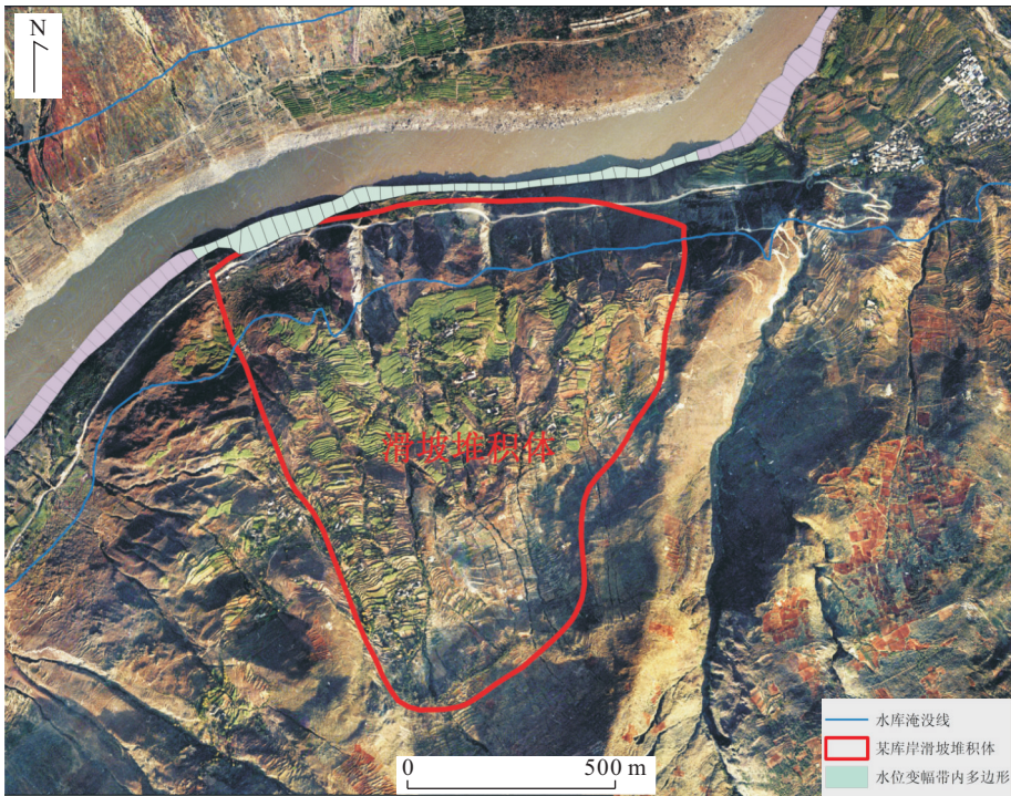
图 6 滑坡堆积体相关的水位变幅带内岸坡多边形及其稳定坡角属性
