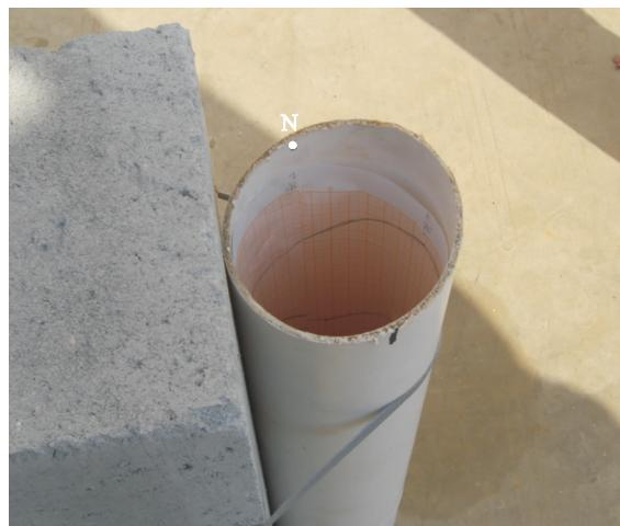
图5 垂直孔产状可靠性试验模型
