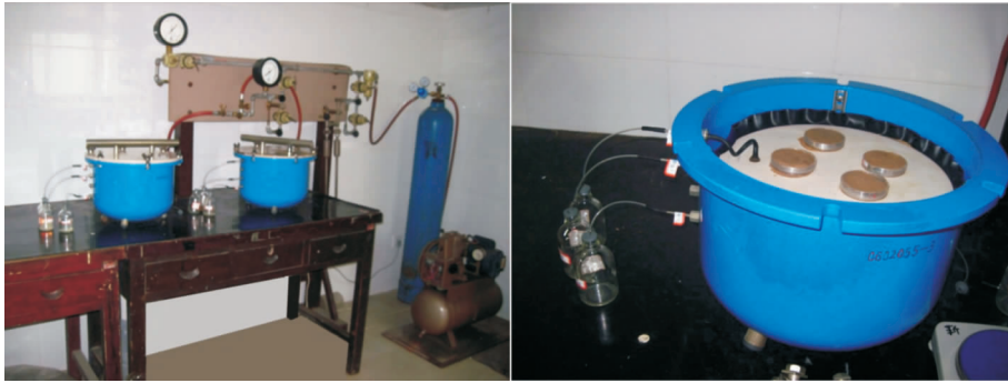
图 3 压力膜仪安装
