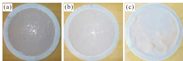
图 6 不同处理阶段的泥饼外观
