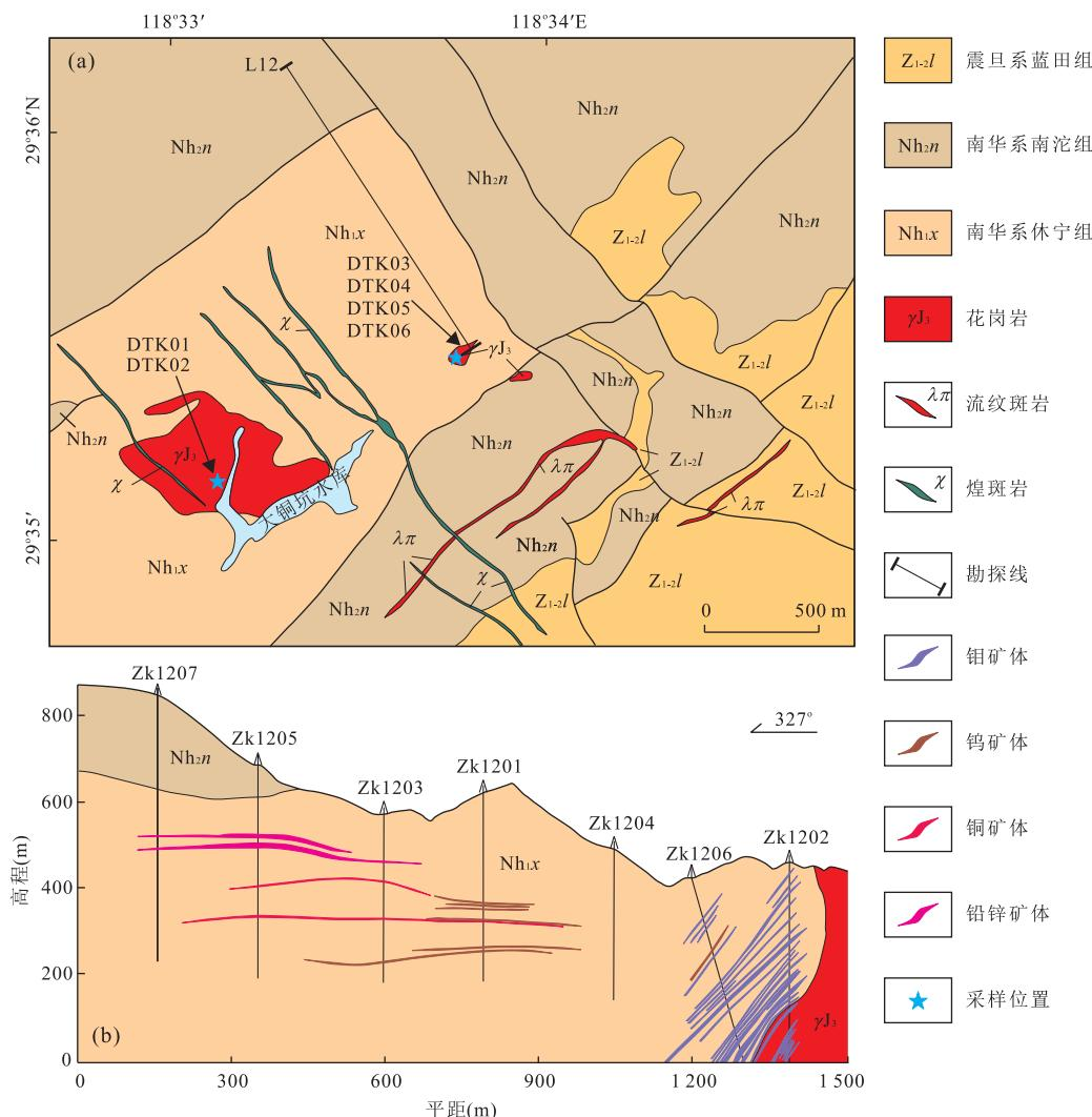
图2 大铜坑钨钼矿区地质图(a)和L12勘探线剖面(b)
