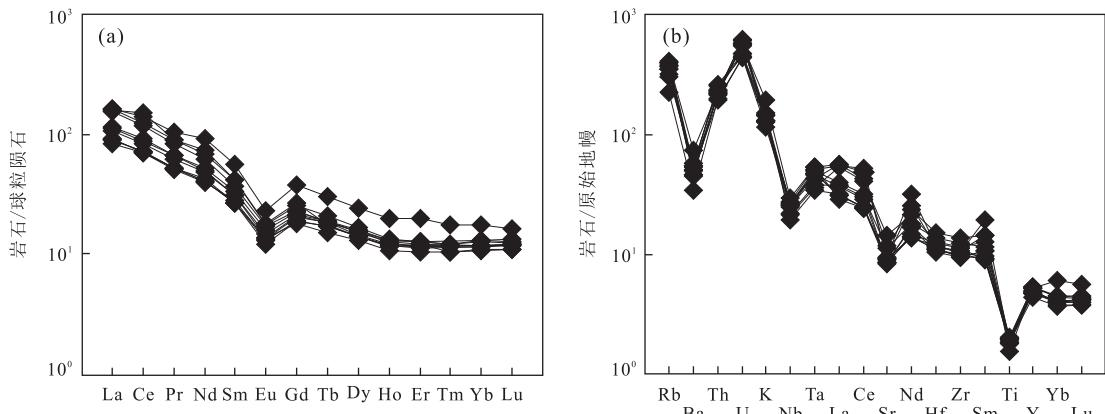
图 5 大铜坑花岗岩稀土元素球粒陨石标准化曲线(a)和微量元素蛛网图(b)
