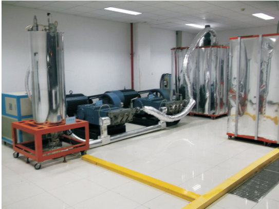
图1 超临界二氧化碳喷射开发页岩气装置
