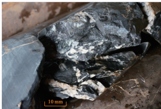
图1 松科2井深部碎块岩石(芯径92 mm)
