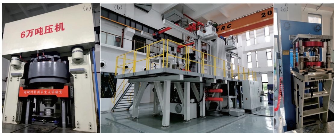
图3 (a)吉林大学6万吨单缸液压机;(b)中国地质大学(武汉)5 000 t多功能大压机;(c)中国地质大学(武汉)改造Kawai型1 000 t多面砧压机
